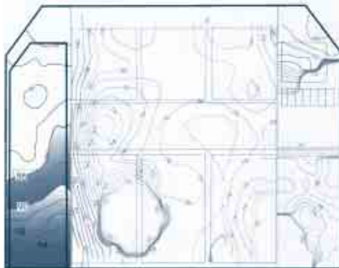
Figura 3. Mapa de intensidad sonora transmitida a través de la pared situada entre la sala de máquinas y la cabina de una locomotora.
